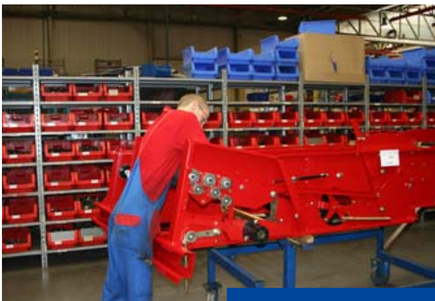
Alle Teile dort, wo man sie braucht: Grimme-Mitarbeiter bei der Montage einer Landmaschine. Bilder: Ottliczky, Industrieanzeiger
