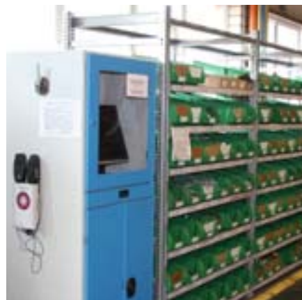
An diesen Terminals ziehen Mitarbeiter den leeren Kanban-Behälter einfach vorbei, was automatisch den Bedarf auslöst
