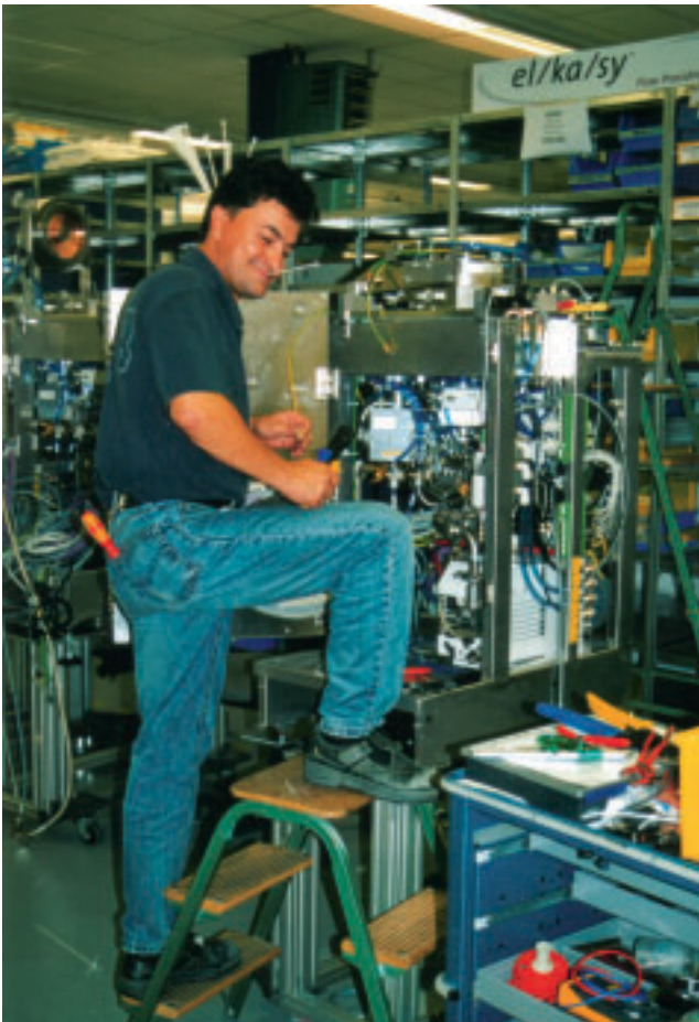
Montage des Metallizers. Steag Hamatech war das erste Unternehmen, das die Fertigung eines gesamten Gerätes, das aus rund 300 Einzelteilen besteht, komplett auf das elektronische Kanban-System Elkasy umgestellt hat (Bilder: Industrieanzeiger)
