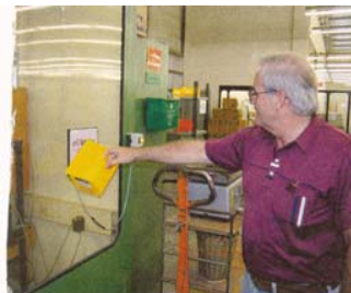
Wird der Transponder am Lesegerät vorbeigeführt, erfolgt automatisch die Bestellauslösung.
